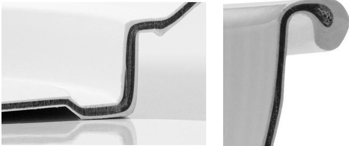
Fig. 2: 3 couches avec cœur en matière moussée pour éviter les marques d'enfoncement.
